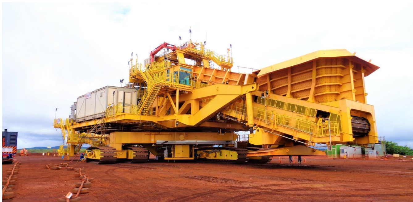
دستگاه سنگ شکن تمام متحرک در سیستم IPCC شرکت MCI
